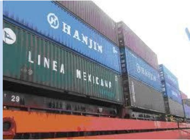
La solidité nécessaire aux manipulations des conteneurs et les contraintes de voyages et d'entreposage obligent une solidité équivalente entre la partie basse et la partie haute, de sorte que la manutention maritime s'effectue par les prises hautes.
